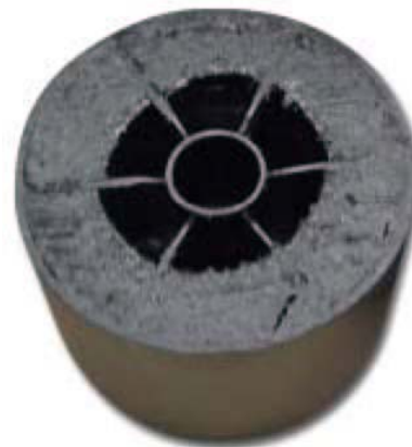
Rotor seccionado con contaminantes
